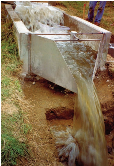
Fig. 56. 2-ft-H-flume near Mettmann/Germany (courtesy Umwelt-Geräte-Technik GmbH Müncheberg).
