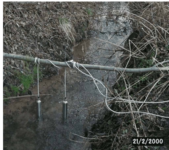
Abbildung 22: Leitfähigkeitssonden an einem Ast über dem Gewässer befestigt
