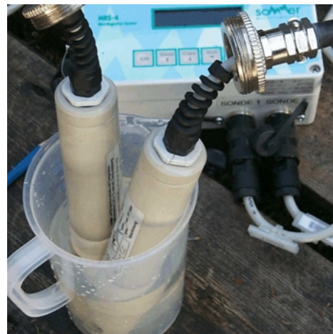
Abbildung 16: Messung der Hintergrundleitfähigkeit im Kalibriergefäß
