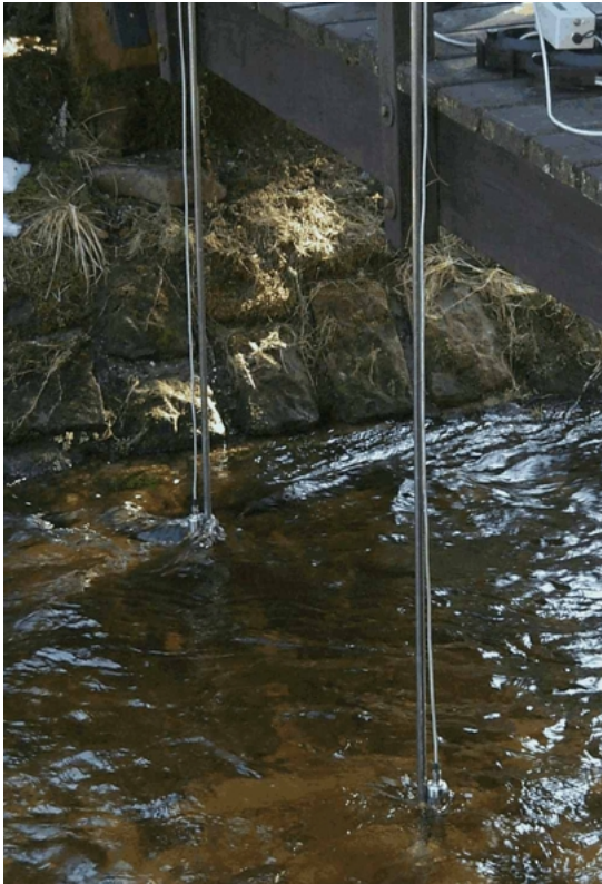
Abbildung 20: Leitfähigkeitssonden an Stangen im Gewässer befestigt
