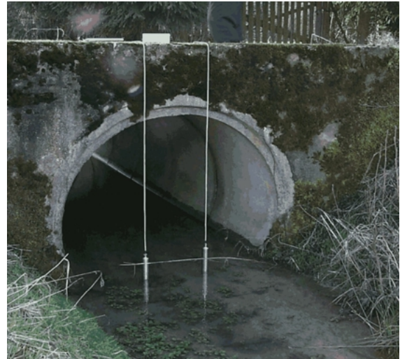
Abbildung 21: Leitfähigkeitssonden von einer Brücke hängend
