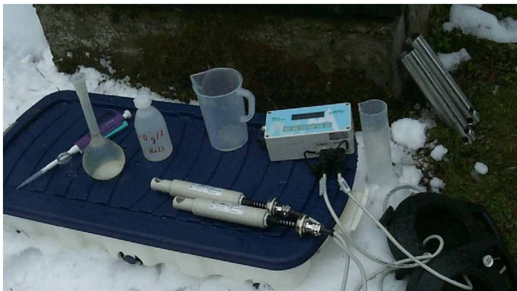
Abbildung 13: Geräte und Materialien zur Kalibrierung von Messsonden
