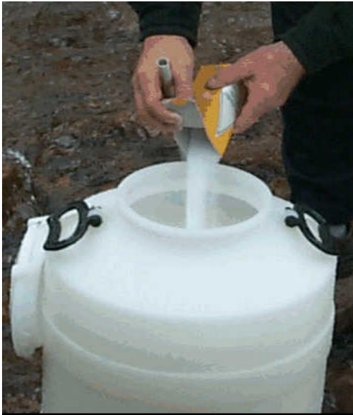
Abbildung 18: Eingabe der zu injizierenden Salzmenge in ein Eingabefäß
