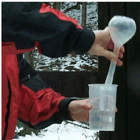
Abbildung 15: Eingabe von 250 ml Bachwasser in das Kalibriergefäß
