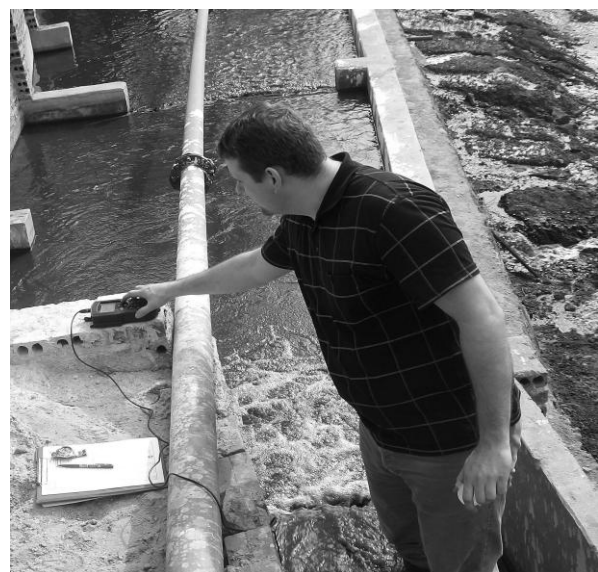
Abb. 3: Durchgangskurve eines Salztracerversuches (links) und zugehörige Messwertaufnahme (rechts)
