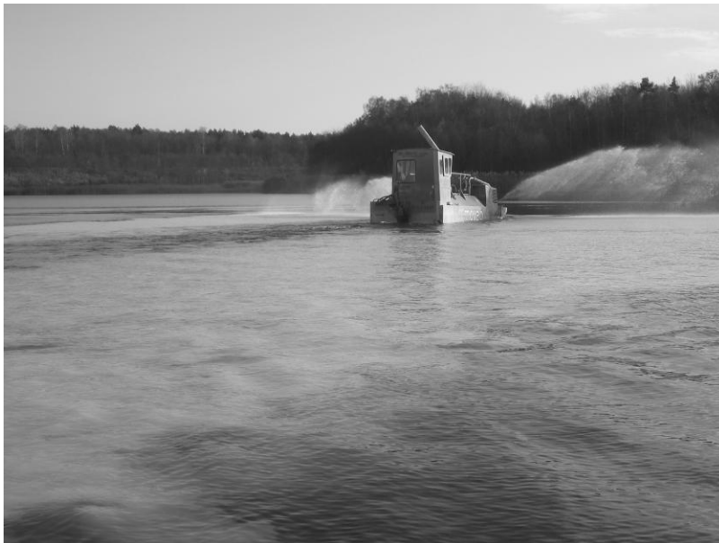
Abb. 3: Einsatzstoffverteilung als Suspension im RL 122
