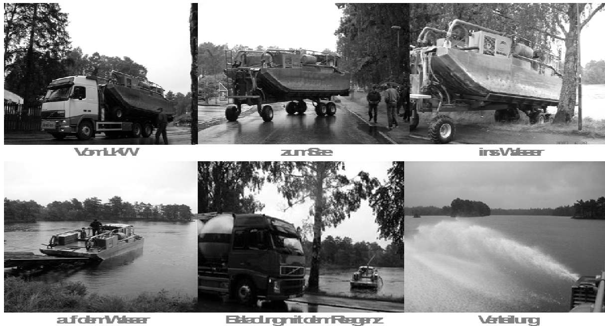
Abb. 4: Mobile Schiffstechnik - Vom Transport zum Einsatz in kürzester Zeit.
