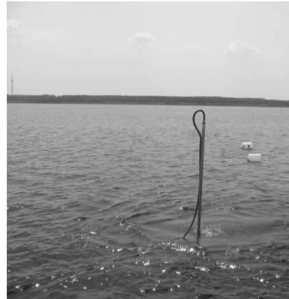
Abb. 2: Gasinjektionslanze. Im hinteren Bereich des Bildes sind 2 Überwachungspunkte zu erkennen.
