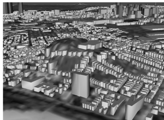
Abb. 5: Virtuelles Geländemodell mit extrudierten Gebäudegrundrissen. Die Grundrisse und Gebäudehöhen lagen als 2D Shapefile vor. Rechts Detail der Geländeanpassung.
