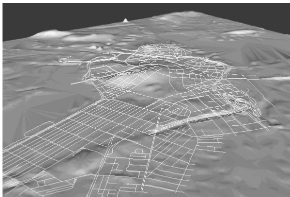
Abb. 4: Überlagerung des Geländemodells mit Vektordaten, die als 2D Shapefile vorlagen. Das rechte Bild veranschaulicht die Anpassung der Vektordaten an das Gelände.
