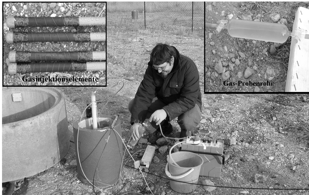
Abb. 3: Grundwasserprobenahme zum \text{SF}_6 -Tracer mittels Gasprobenrohr (Gasmaus), oben links Gazeummantelte Injektionselemente an der Basis der Injektionslanzen.
