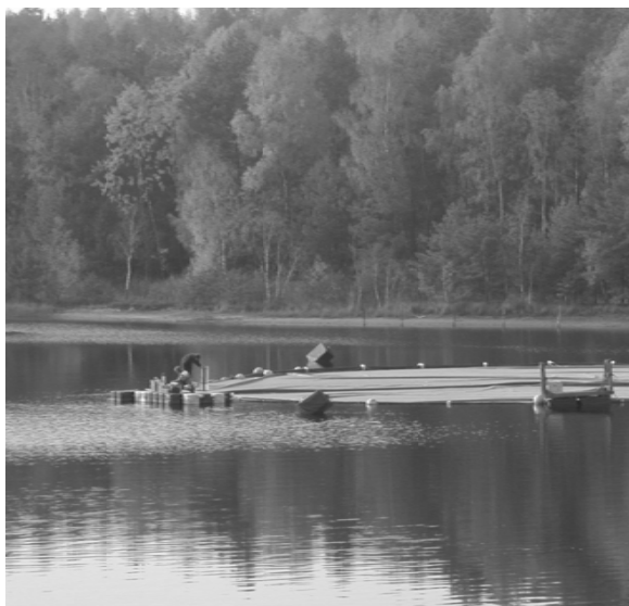
Abb. 1: Mit Schwimmfolie abgedeckter Enclosure (Durchmesser 30 m). Größenvergleich: Personen auf Arbeitsfloß am linken Rand.
