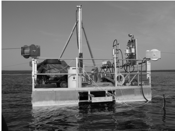
Abb. 1: Autonom arbeitende Schwimmplattform inkl. Monitoringschrank und Gasregeltafeln.
