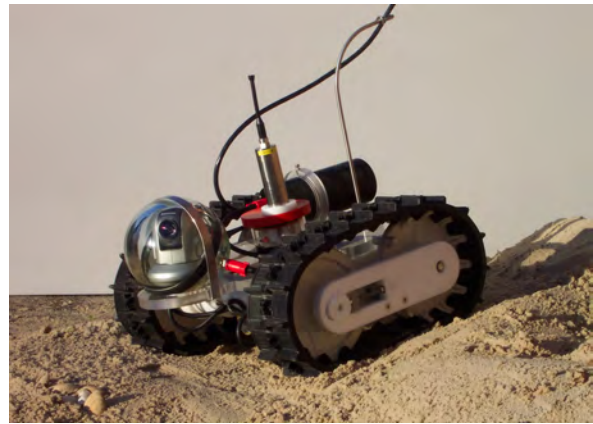
Abb. 4: SeepFinder, ein an der IUB entwickelter Crawler (Unterwasser-Roboter).
