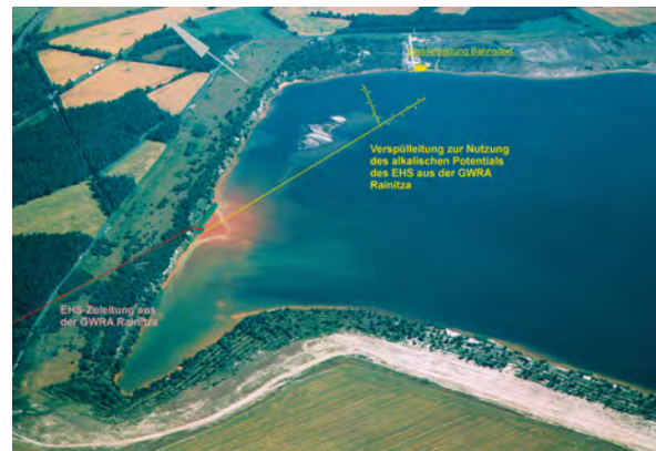
Abb. 5: Nutzung von alkalischem EHS im TBS Sedlitz.
