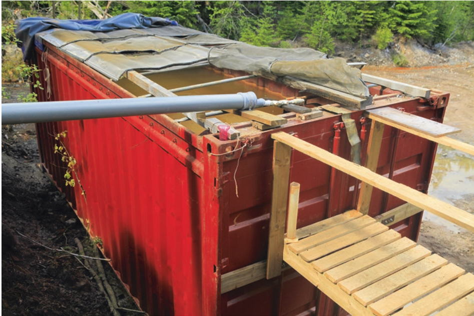
Abb. 4.20 Containerisierter Vertikaldurchflussreaktor (VFR) am finnischen Polymetallbergwerk Metsämonttu mit Belüftung des Grubenwassers (Sansox Oy OxTube). Der Auslauf des Reaktors mit Messwehr für den Durchfluss befindet sich am hinteren Ende des 20'-Containers. Wasservolumen 24 m 3
