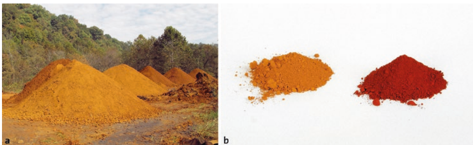
Abb. 7.6 Halden mit Ocker aus einer passiven Grubenwasserreinigung nach dem Entwässern und Trocknen (a) und getrockneter sowie gebrannter Ocker (b). (Fotos: Bob Hedin)
