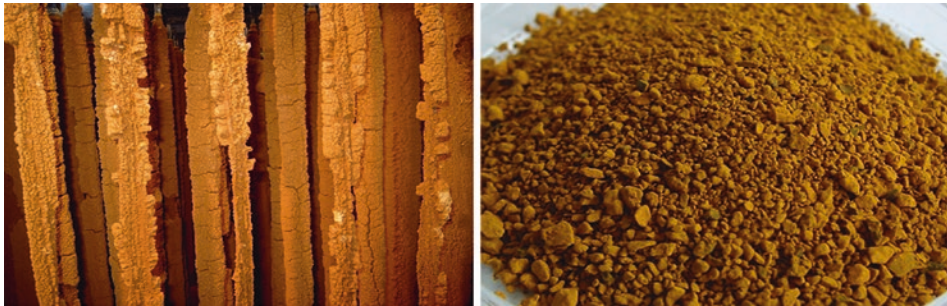
Abb. 3.26 Schwertmannit auf Aufwuchselementen ( links , Bildbreite ca. 2 m) und mikrobiell hergestellter Schwertmannit ( rechts , Bildbreite etwa 15 cm) (Fotos: Eberhard Janneck)
