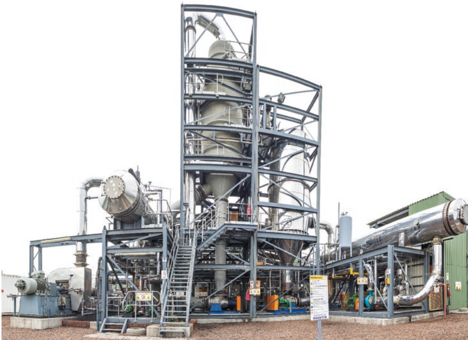
Abb. 3.33 Proxa-Gefrierkristallisation am Tagebau der New Vaal Colliery der Anglo American Coal in Südafrika (Foto: Jochen Wolkersdorfer)
