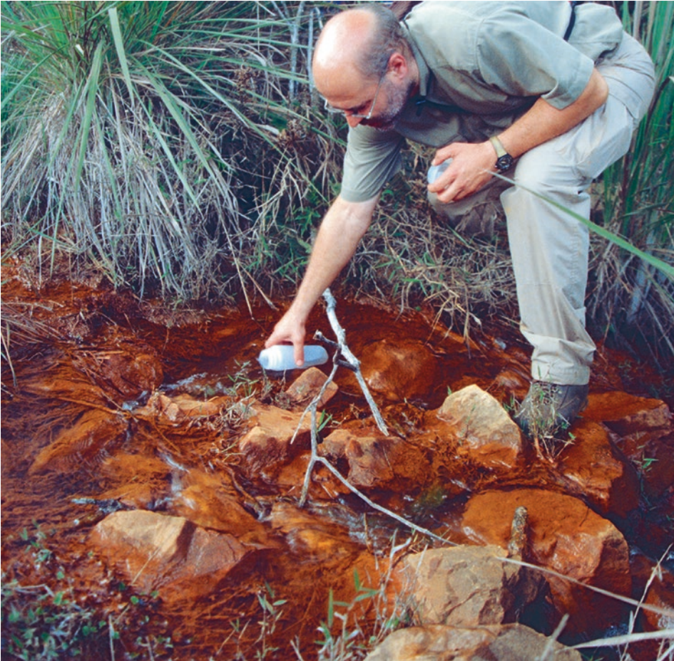
Abb. 4.7 Ehemaliges offenes Carbonatgerinne an der Mina de Campanema/Minas Gerais in Brasilien. Die Verockerung der Kalksteine ist deutlich zu sehen
