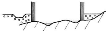
Abb. 159. Die Sohle des Grundwassers bildet ein Relief. In den Mulden sammelt sich das Wasser
