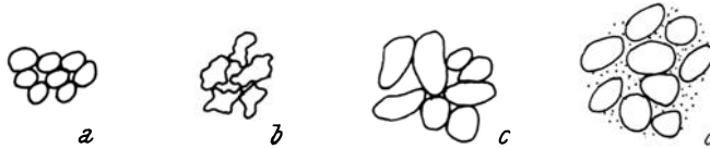
Abb. 96. Das Porenvolumen wird durch die Korngröße, Kornform und Lagerung beeinflusst, a) gleich große Körner mit glatter Oberfläche erzeugen kleine Poren, b) Körner mit rauher Oberfläche vergrößern das Porenvolumen, c) Körner mit sperriger Lagerung vergrößern das Porenvolumen, d) kleine Körner zwischen größeren verkleinern das Porenvolumen
