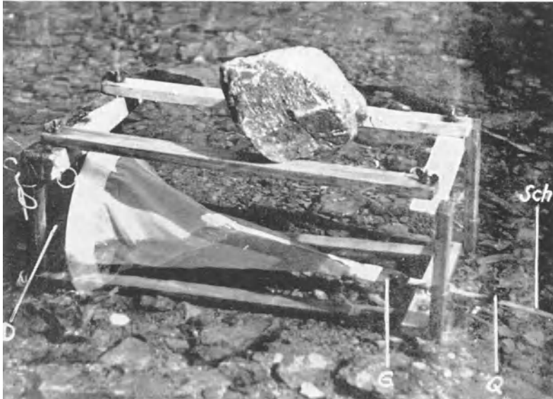
Abb. 87. Planktonnetz nach ZOTL (Länge 40 cm, Durchmesser 14 cm, Holzrahmen 20 \times 20 \times 40 cm)
