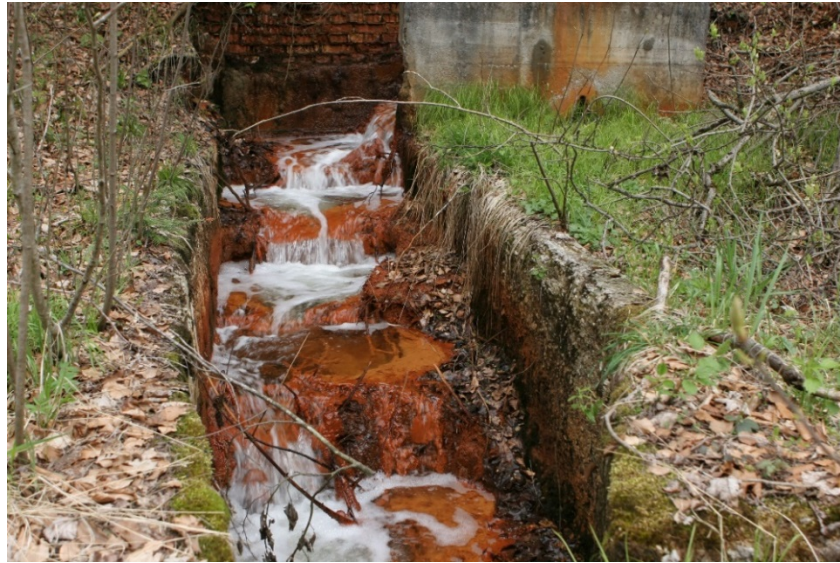
Abbildung 87: Oxidationskaskade des Ventilatorstollens an der Leitzach, Oberbayern. Durchfluss etwa 2 \text{ m}^3 \text{ min}^{-1} . Breite des Kanals etwa 1 m. Zwischenzeitlich völlig umgebaut.
