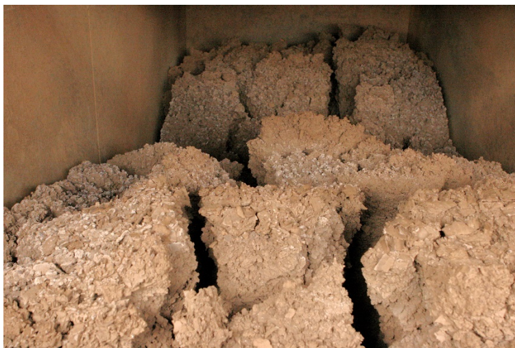
Abbildung 40: Durch Filterpressen entwässerter Schlamm (Sauerwasserreinigungsanlage Flughafen Halifax, Neuschottland, Kanada; Bildbreite ca. 1 m).
