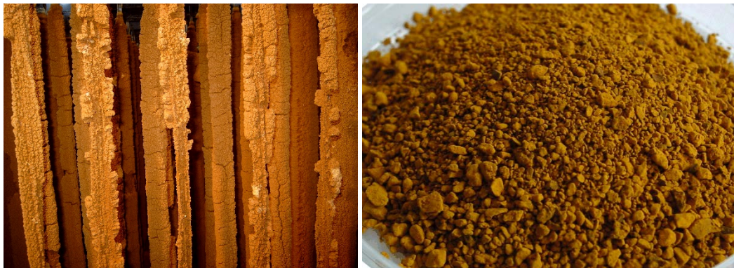
Abbildung 58: Schwertmannit auf Aufwuchselementen (links, Bildbreite ca. 2 m) und mikrobiell hergestellter Schwertmannit (rechts, Bildbreite etwa 15 cm) (Fotos: Eberhard Janneck).
