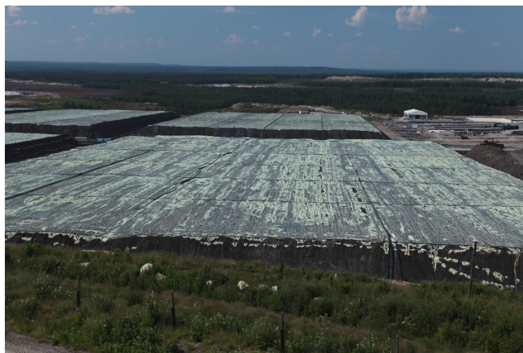
Abbildung 96: Haldenlaugung am finnischen Nickelbergwerk Terrafame (ehemals Talvivaara).
