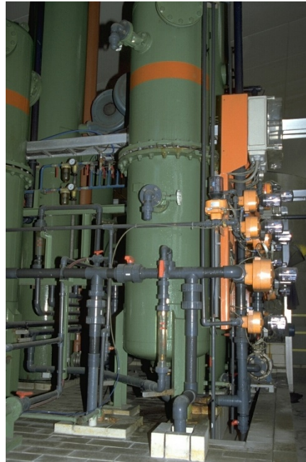
Abbildung 61: Industrieller Ionenaustauscher zur Abwasserbehandlung aus der Kupferelektrolyse in den Montanwerken Brixlegg/Tirol.
