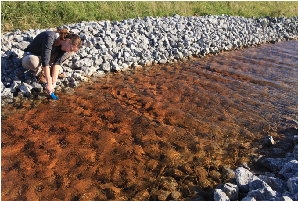
Abbildung 71: Offenes Carbonatgerinne mit Eisenhydroxidausfällungen am Grubenwasseraustritt des ehemaligen Kohlenbergwerks Dominion № 11 auf der Kap-Breton-Insel, Neuschottland, Kanada.
