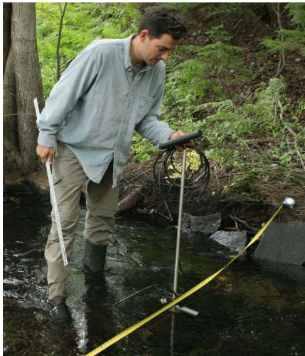
Abbildung 20: Durchflussmessung mit einem akustisch-digitalen Strömungsmessgerät in einem durch Grubenwasser beeinflussten Bach (Kap-Breton-Insel, Neuschottland, Kanada). Der Bearbeiter steht korrekt abstromig des Messgeräts und hält das Gerät weit weg vom Körper, um den Durchfluss möglichst nicht zu beeinträchtigen.
