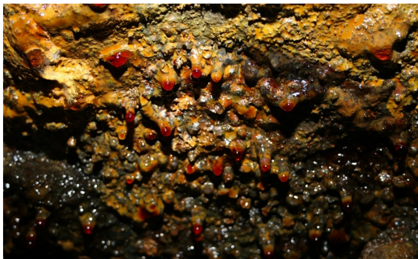
Abbildung 8: Tropfen sauren Grubenwassers mit pH 2 an der Firste eines Stollens im Besucherbergwerk Grube Glasebach in Straßberg/Harz. 2. Sohle, Bereich des Pyritganges (Bildbreite ca. 20 cm).
