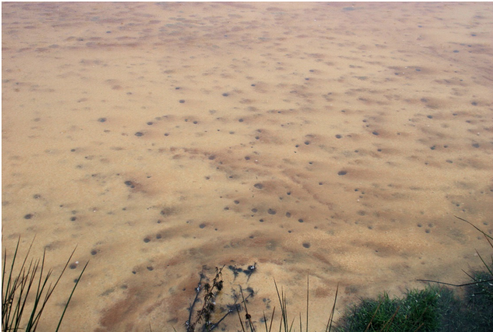
Abbildung 77: Durch Gasanstieg hervorgerufene Kanäle auf der Oberfläche des mit Eisenoxihydraten bedeckten organischen Substrats im RAPS Bowden Close, Landkreis Durham, England. Durchmesser der Kanäle im Zentimeterbereich; Bildbreite in der Mitte etwa 3 m.
