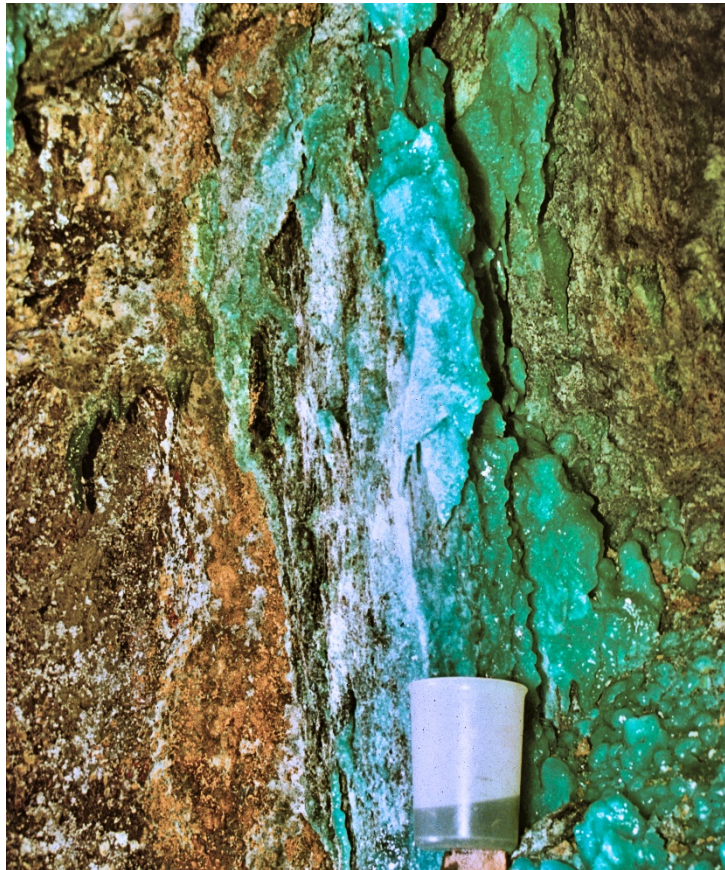
Abbildung 6: Stalaktit aus Melanterit oberhalb der Pfütze, in der Alpers und Nordstrom das Grubenwasser mit einem pH-Wert von -3,6 gemessen haben. Das Grubenwasser im Eimer hat einen pH-Wert von -0,7 und eine Temperatur von 35\text{ °C} (pers. Mitt. Kirk Nordstrom 2019; Foto: Kirk Nordstrom & Charly Alpers). Maßstab: Kunststoffeimer.
