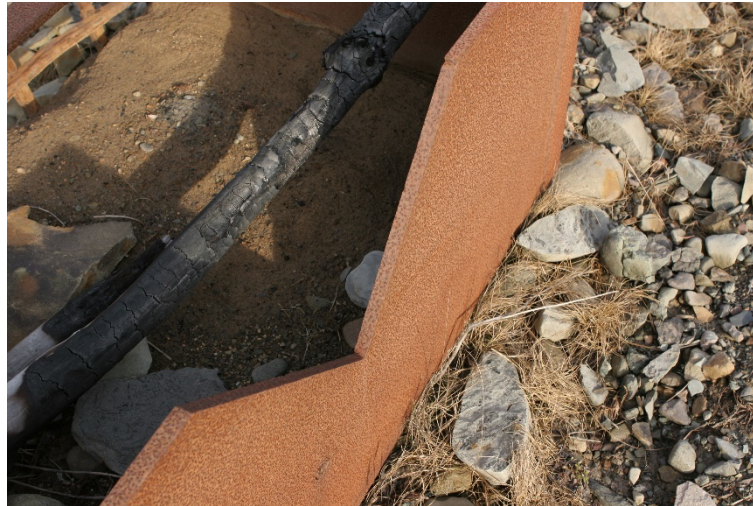
Abbildung 22: Falsch konstruiertes Dreieckswehr für einen Grubenwasseraustritt des 1 B Mine Pools auf der Kap-Breton-Insel, Neuschottland, Kanada. Die Wehrplatte ist zu dick (2 cm), besteht aus nichtrostfreiem Material, und es fehlt die abgeschrägte, wasserseitige Abrisskante. Das Messwehr war über einen Zeitraum von ca. 1 Jahr im Einsatz, um Durchflüsse mit „hoher Genauigkeit“ zu messen.
