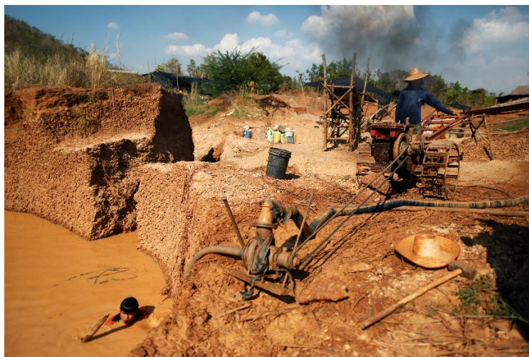
Abbildung 1: Kleinbergbau auf Gold in Panompa bei Pichin in Thailand. Zwei Arbeiter installieren eine Pumpe zum Sumpfen ihres Abbaues. (© REUTERS/Damir Sagolj)
