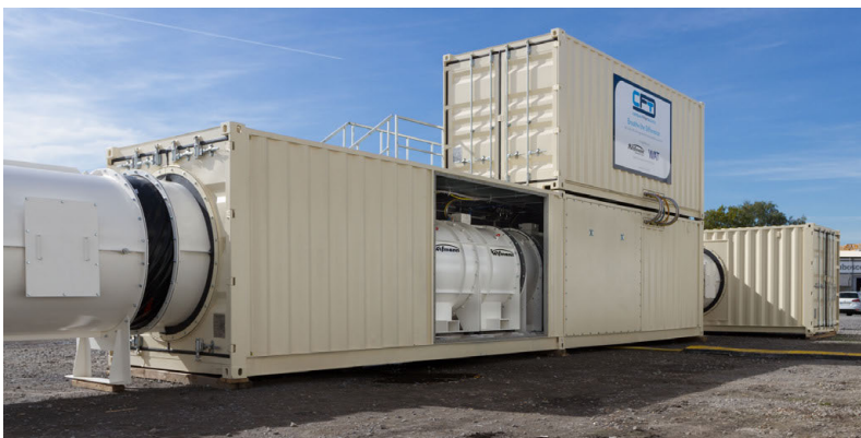
Bild 6: Geöffnete Revisionsöffnung des Lüftercontainers, dahinter Axialventilatoren
