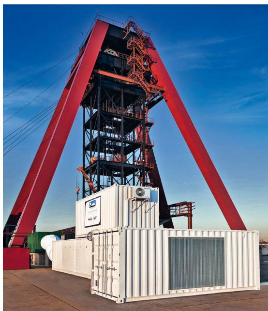
Bild 7: Inbetriebnahme der Schachtbewetterungsanlage für Schacht 2 auf dem Bergwerk in Weißrussland
