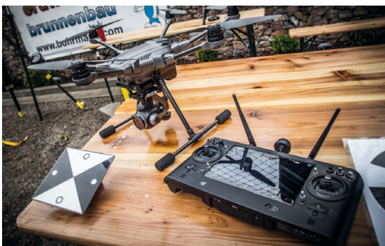
Bild 6: Drohne und Zubehör zur Messung der Bestandsdaten im Gelände
