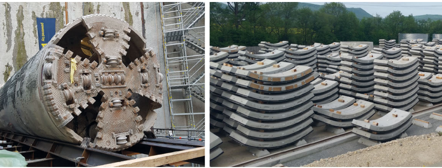
Bild 3: Tunnelvortriebsmaschine und Lagerplatz für Tübbingsegmente (beispielhaft)
