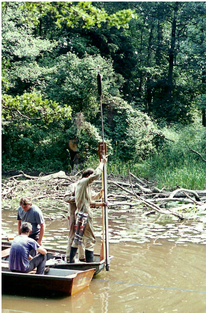
Abb. 4.1: Probennahme eines Unterwassersedimentkerns mit dem BEEKER SAMPLER
