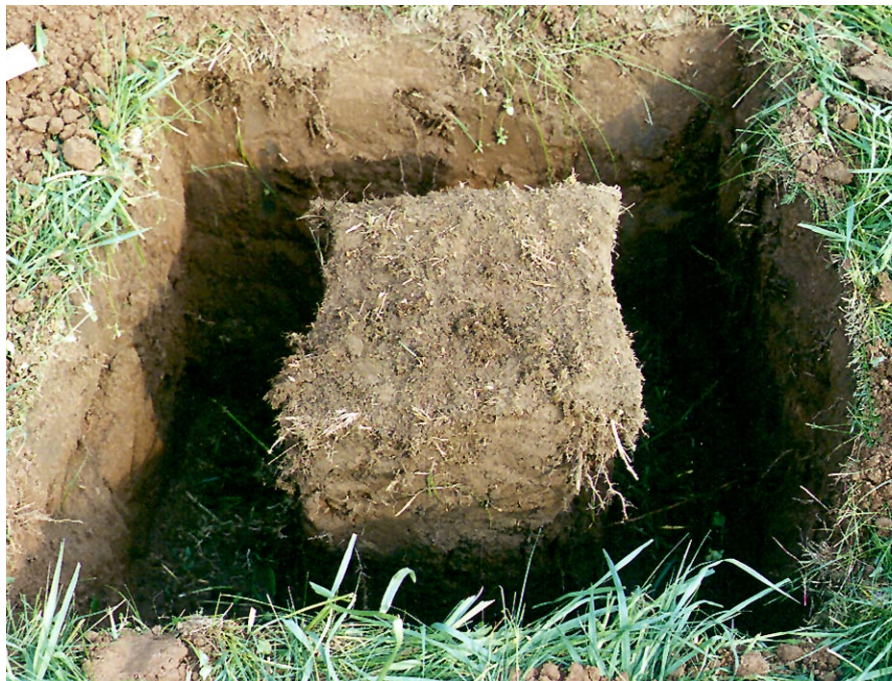
Abb. 4.3: Gewinnung von Oberflächenproben aus Auenböden
