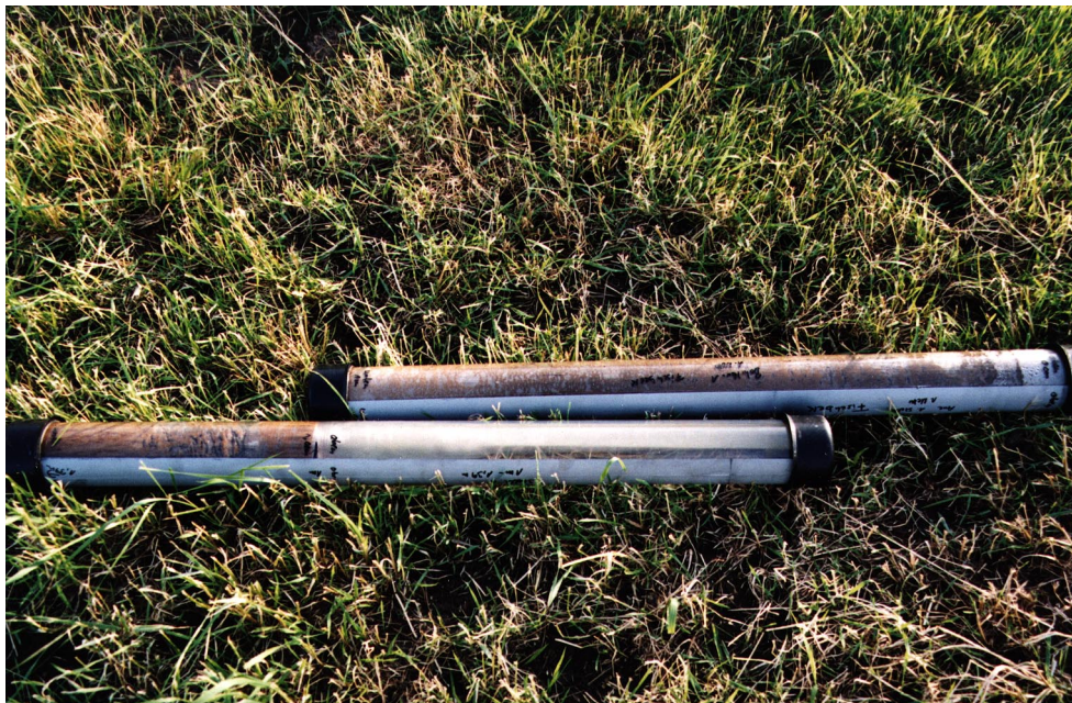
Abb. 4.2a: Sedimentkern nach der Entnahme aus dem Bohrgerät (Plexiglashalbschalen an den Enden und längsseitig verschlossen)
