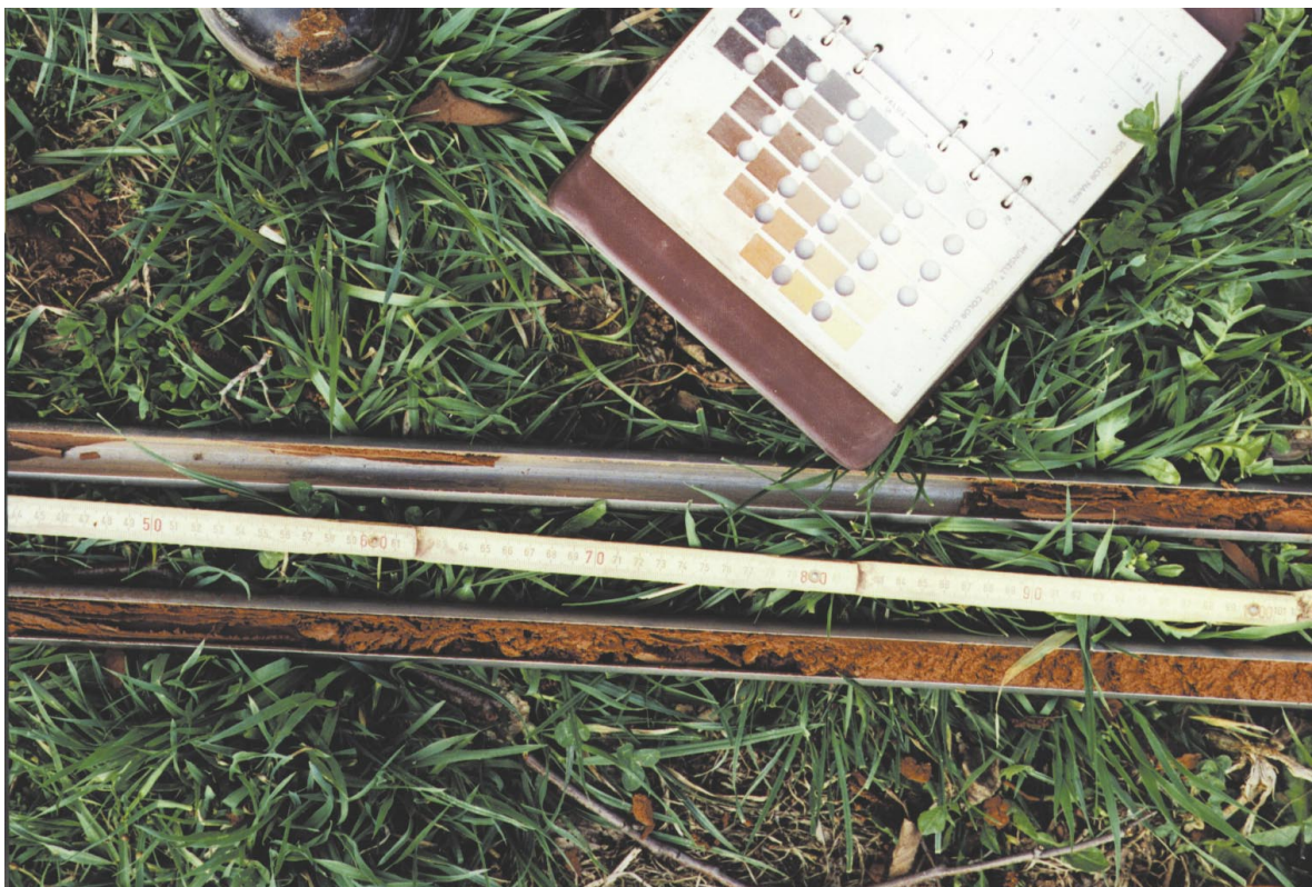
Abb. 4.1 b: Sondierungsarbeiten - Pürckhauer mit Bohrgut sowie Munsell-Farbtafel
