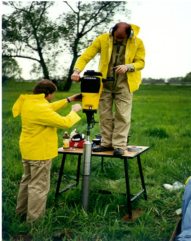
Abb. 4.2: Probennahme von Auenkernen mit dem Stechrohr-Bohrgerät nach Merkt und Streif bei Hradec Králové
